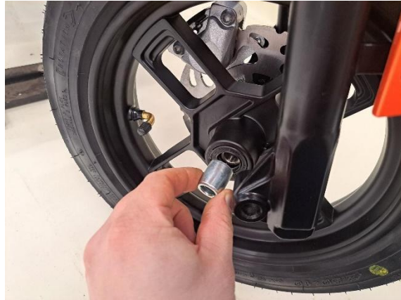
Laita pitempi holkki etupyörään paikoilleen.
