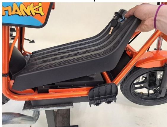
Laita akkukotelon kansi paikoilleen.
