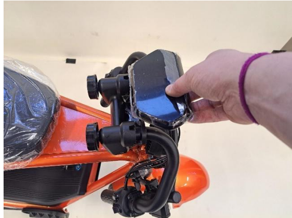
Laita mittaristo paikoilleen irroitetuilla kiinnityspulteilla (kuusiokoloavain 5mm).
