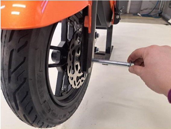
Työnnä etuakseli puoliksi paikoilleen.
