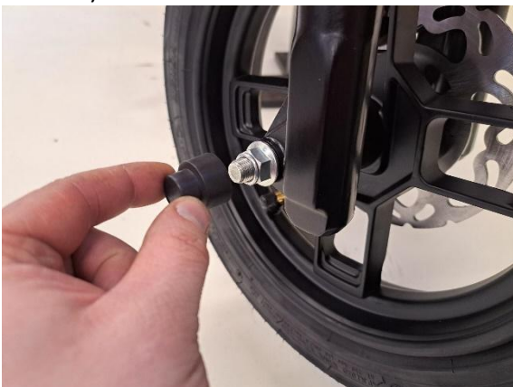
Laita tulpat paikoilleen.
