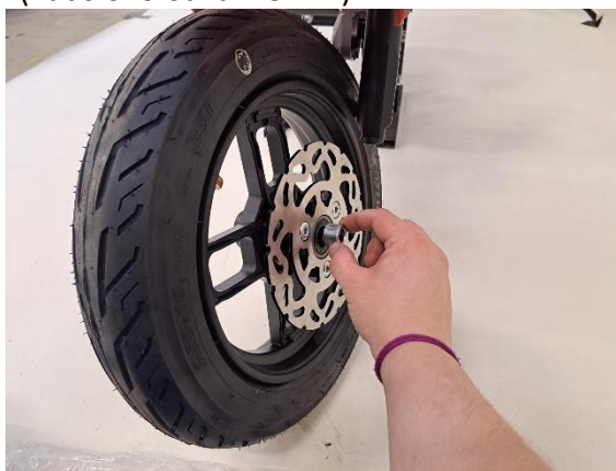
Laita lyhyempi holkki etupyörään jarrulevyn puolelle.
