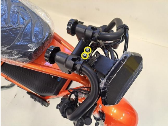
Irroita mittariston kiinnityspultit (kuusiokoloavain 5mm).
