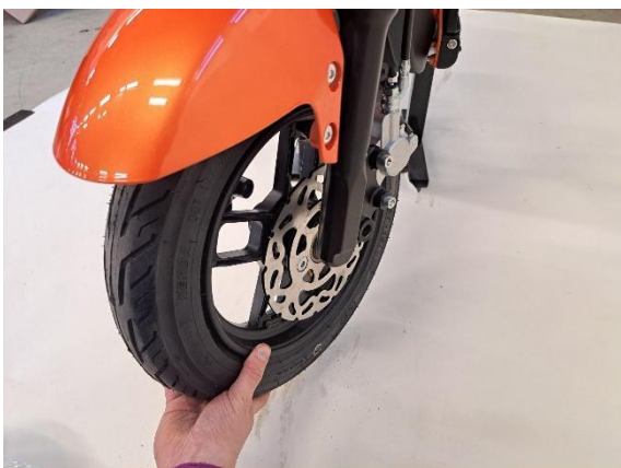
Nosta etupyörä paikoilleen.
