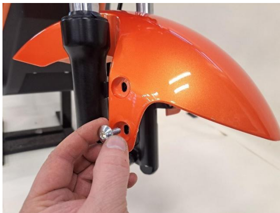
Kiinnitä etulokasuoja neljällä kupukantaisella kiinnityspultilla (kuusiokoloavain 5mm).
