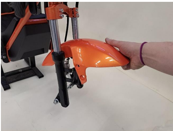
Laita etulokasuoja paikoilleen.
