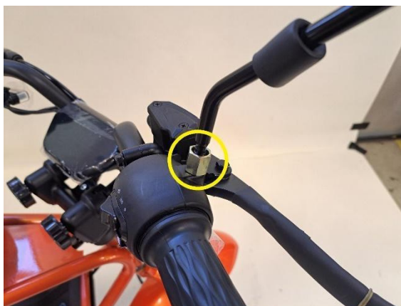
Oikean asennon löydyttyä kiristä mutterit (kiintoavain 14mm). Laita suojat muttereiden päälle.
