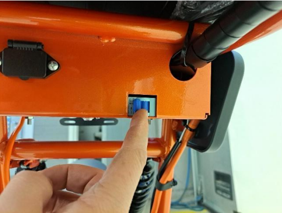
Käännä päävirtakytkin ON-asentoon.
