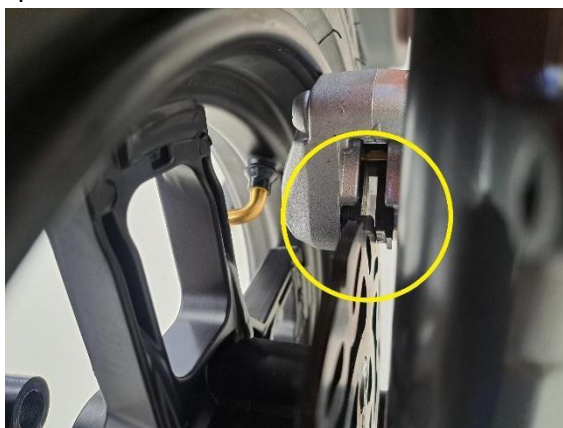
Katso, että jarrulevy asettuu etujarrupalojen väliin.
