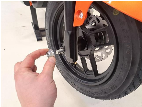
Työnnä etuakseli kokonaan läpi ja laita kiinnitysmutteri paikoilleen (kiintoavain 17mm).
